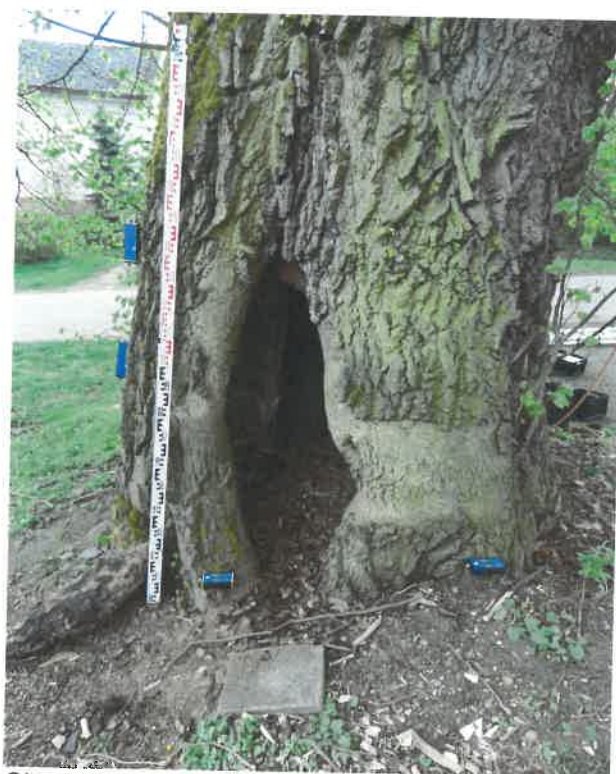
Obr. 9-10: Pozice přístrojů při tahové zkoušce
